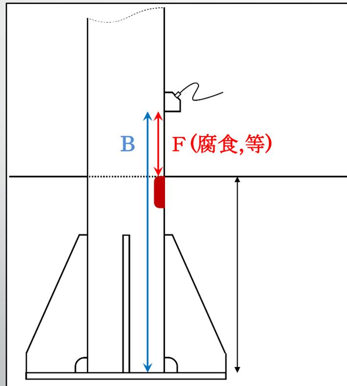
一探触子 試験片評価法
