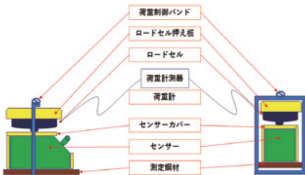
図-4 ロードセル取り付け固定治具
