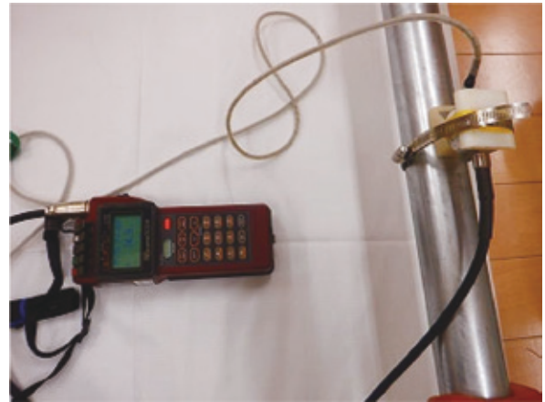
写真-6 ロードセル荷重計セット状況
